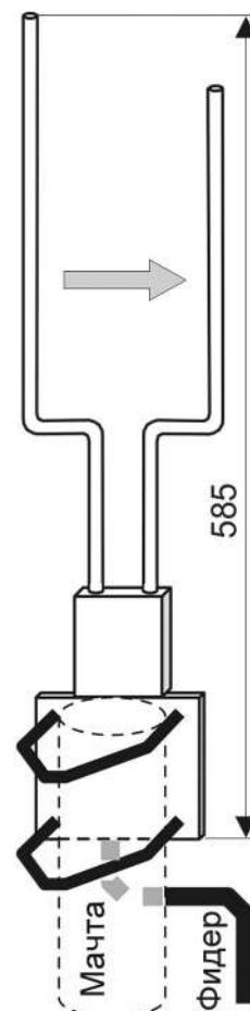
**ВНИМАНИЕ!** Чтобы обеспечить защиту от попадания грозового разряда, основание антенны необходимо надежно заземлить! Использовать в качестве контура заземления трубы водопровода, отопления и т.п. не допускается!
